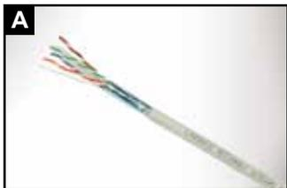
A 采用剥线刀去除外表护套
