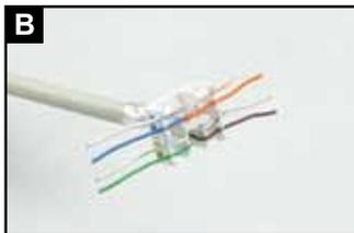
B 将导线按所定的线序要求依次嵌在对应的端接模块线槽中
