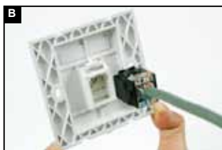
将已完成的打线的模块置于面板背部
