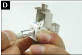
按照颜色线序戴上锁扣式端接帽
